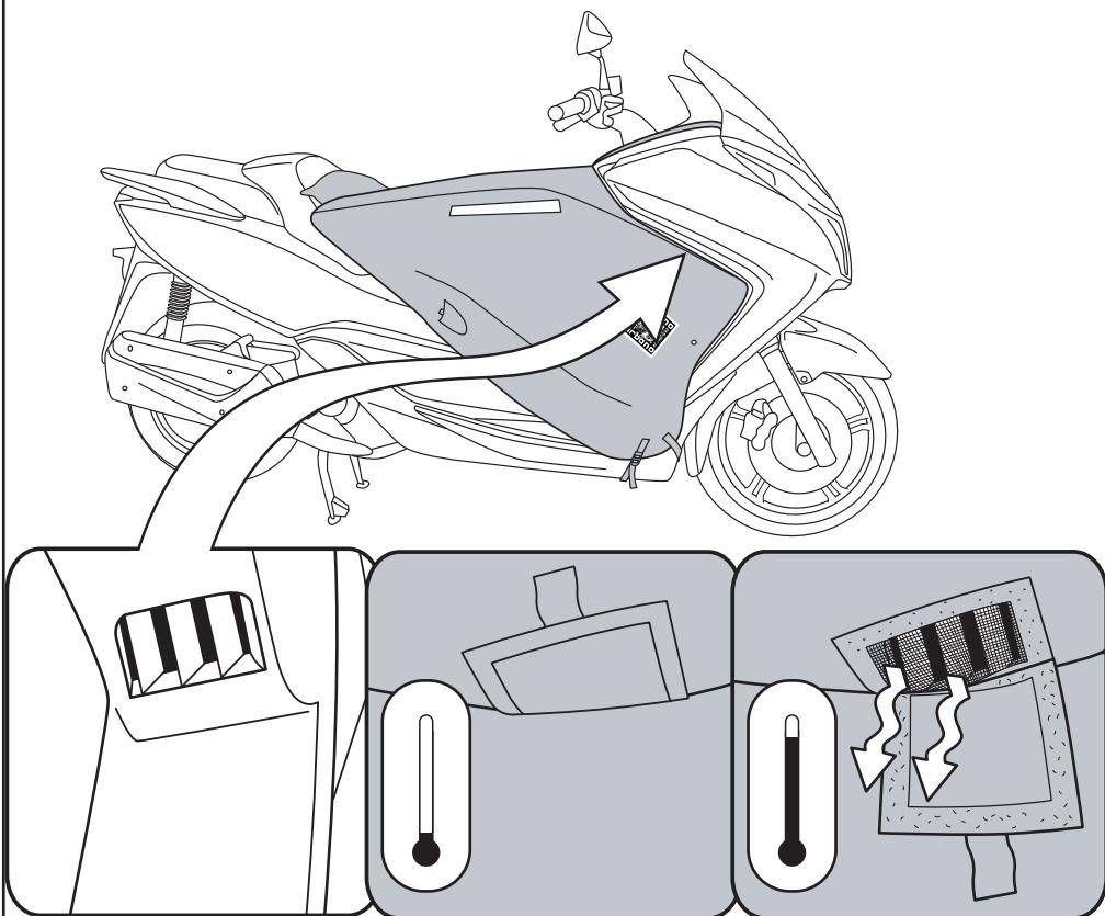
**I** In posizione aperta il deflettore convoglia l'aria calda del radiatore all'interno del Termoscud®. In posizione chiusa il deflettore evita l'entrata di aria fredda (a motore freddo) all'interno del Termoscud®. Sistema brevettato.
