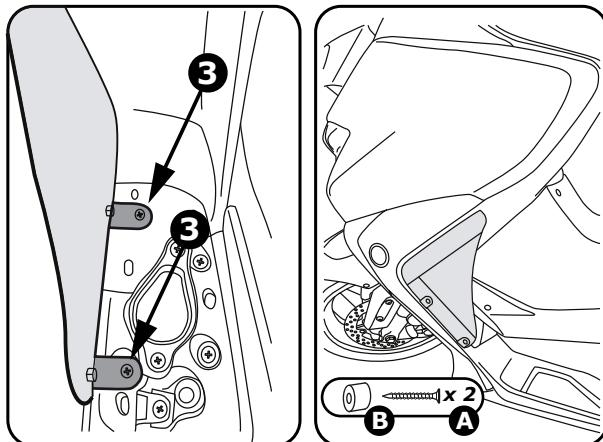
**F** Enlever la vis du point 3. Monter le profil rigide sur ce trou en utilisant la vis (A) dans les bagues-entretoise (B) en dotation.
