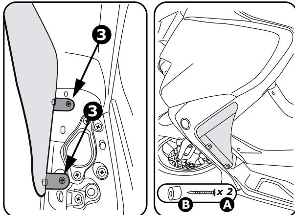
**I** Rimuovere le viti dello scooter nei punti 3. Montare su questi fori il profilo rigido usando la vite (A) attraverso i distanziatori (B) forniti in dotazione.
